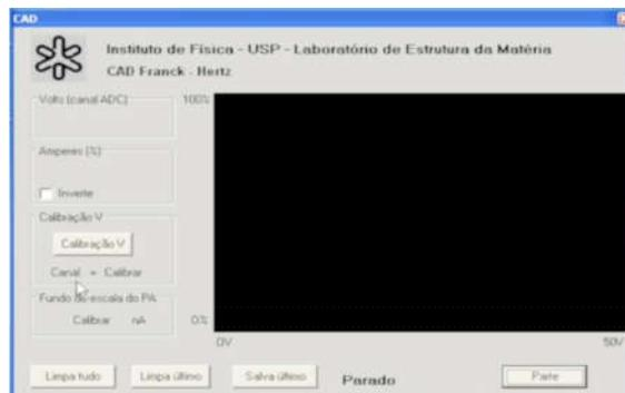
0.1.9 No programa **FH32** faça a calibração dos canais de tensão e corrente. Ao acionar o comando **calibração V** aparecerá uma tela pequena de calibração de voltagem como a mostrada na figura abaixo. Aperte a tecla **Liga CAD** e introduza, manualmente o valor do potencial  $V_A$  registrado pelo voltímetro. Entre com o valor de corrente igual a  $1nA$  e acione a tecla **calibra** e depois a tecla **Ok**.
