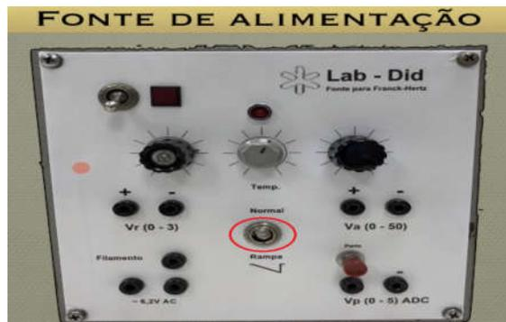
0.1.11 Coloque o potenciômetro que regula o potencial acelerador (a sua direita) no valor máximo.
