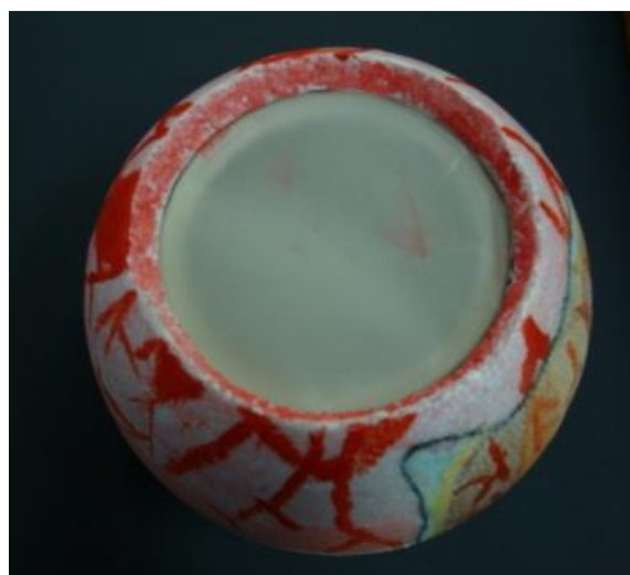
Foto 3: A parte da circunferência branca que aparece na foto é o anteparo da câmara escura feita com a lata de Nescau, esta parte serve como analogia entre o anteparo e a retina do olho humano, onde acontece a formação da imagem.
