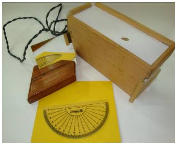
\*O **projedor de fenda** é uma caixa de madeira ou alumínio, constituída de uma abertura ajustável por onde passa a luz proveniente do filamento da lâmpada fixada em seu interior.
