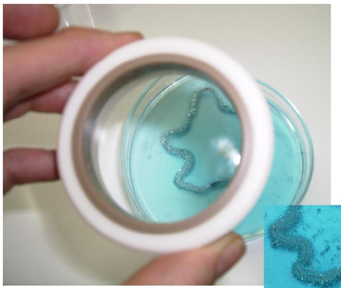
**Figura 1: Experimento do fio de cobre em nitrato de prata.**
