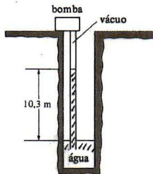
Figura 12-5. A forma errada de retirar água de um poço, mas que poderia ser usado como barômetro.
