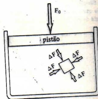
Figura 12-1. Forças sobre um cubo imerso num fluido sob pressão.
