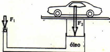
Figura 12-2. Macaco hidráulico elevando um automóvel.
