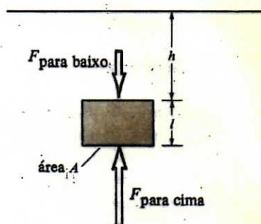
Figura 12-7. Bloco de volume  $lA$  submerso num líquido de densidade  $\rho$ .  $F_{\text{cima}}$  e  $F_{\text{baixo}}$  são forças do líquido atuando sobre o bloco.
