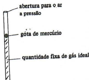
Figura 12-9. Termômetro a gás a pressão constante.
