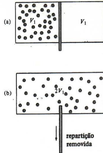
Figura 12-11. Expansão livre de um gás. Em (b) a repartição foi removida.
