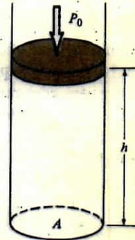
Figura 12-3. Coluna de líquido de altura  $h$ . Pressão externa  $P_0$  aplicada no topo.
