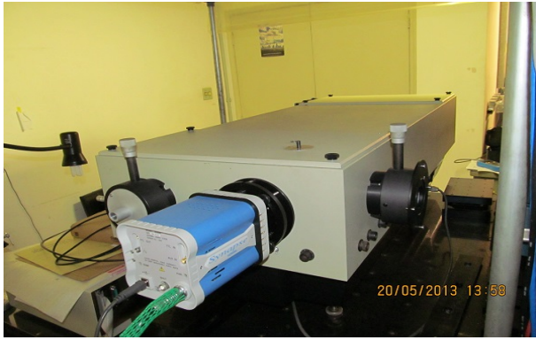
Fig.7 Foto do monocromador THR1000 com CCD que será usado para obter o perfil de temperatura iônica no tokamak TCABR .
