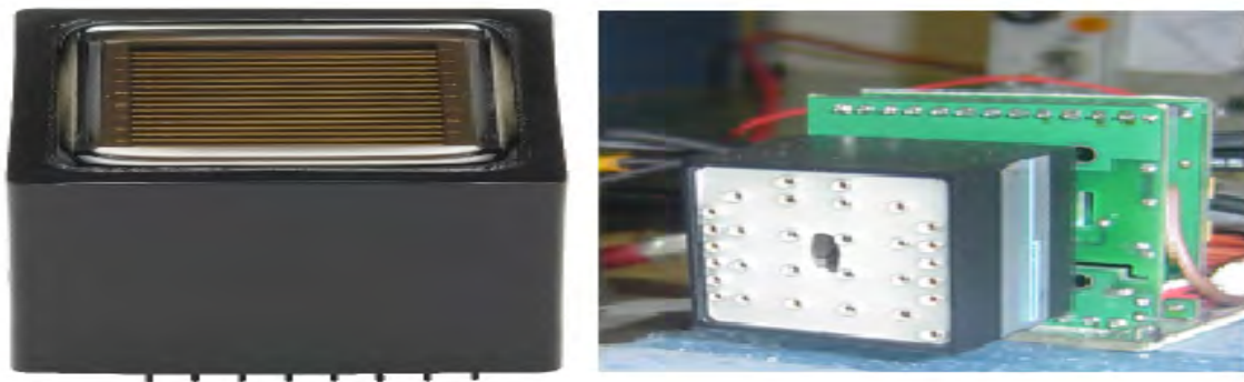
Fig.4 A direita, foto do detetor Ma-PMT modelo L16. A esquerda soquete para o modelo L16.
