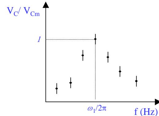
O gráfico é aparentemente o mesmo. Mudou apenas a escala do eixo 'Y =  $V_C/V_{max}$ '. Agora basta superpor a função teórica com os valores nominais de R, L e C e discutir eventuais discrepâncias do modelo. (Note que o ponto máximo  $V_{Cm}$  pode não estar exatamente em  $\omega_1/2\pi$ . Isso causará um deslocamento do 'modelo x dados experimentais' que pode ser facilmente corrigido.)
