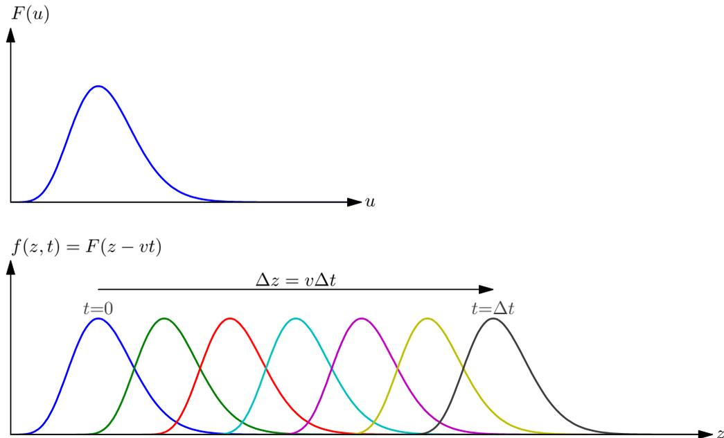
Figura 5.1: A propagação de uma onda. Encima: a função de uma única variável  $F(u)$ . Embaixo: a função  $f(z, t) = F(z - vt)$  representada numa série crescente de instantes  $t$  separados pelo mesmo intervalo de tempo. Depois de um intervalo de tempo  $\Delta t$  a onda se deslocou no espaço por uma distância  $\Delta z = v\Delta t$ .
