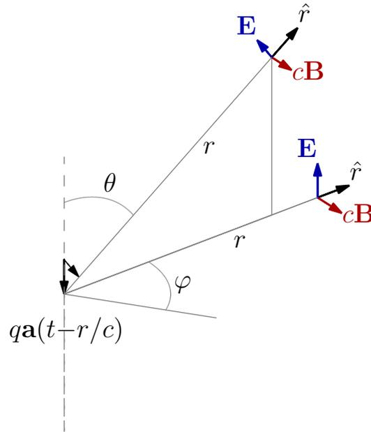
Figura 5.5: Campo de radiação de uma carga acelerada.
