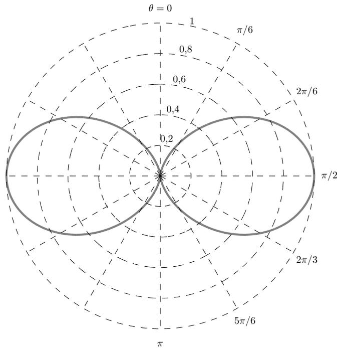
Figura 5.6: Distribuição angular da intensidade irradiada por uma carga acelerada que se move na direção  $z$ . Este é um gráfico polar: a intensidade da onda emitida numa dada direção é proporcional à distância entre a origem e o ponto da curva nesta direção. Esta curva pode ser girada em torno do eixo  $z$ .
