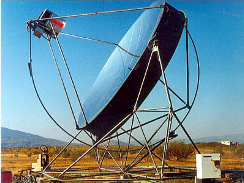
Disco Stirling de la plataforma solar de Almería
