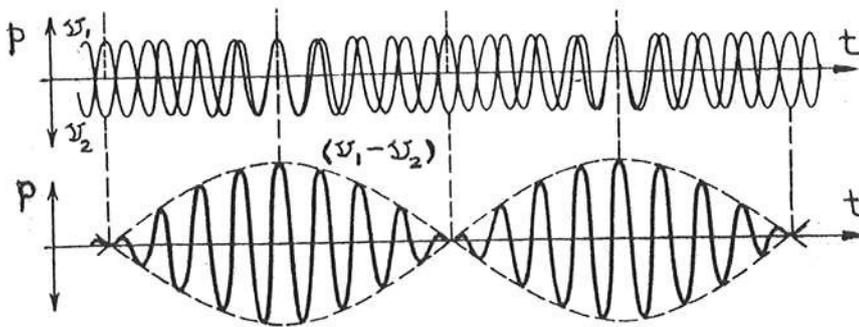
Figura 11: *Batimento entre duas ondas harmônicas.*
