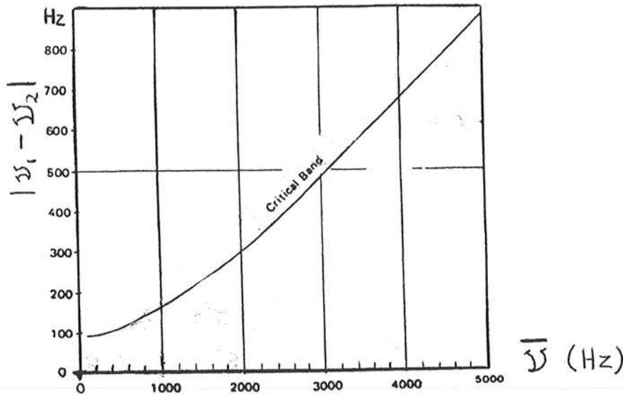
Figura 10: *Largura da banda crítica em função da frequência (Referência 8).*
