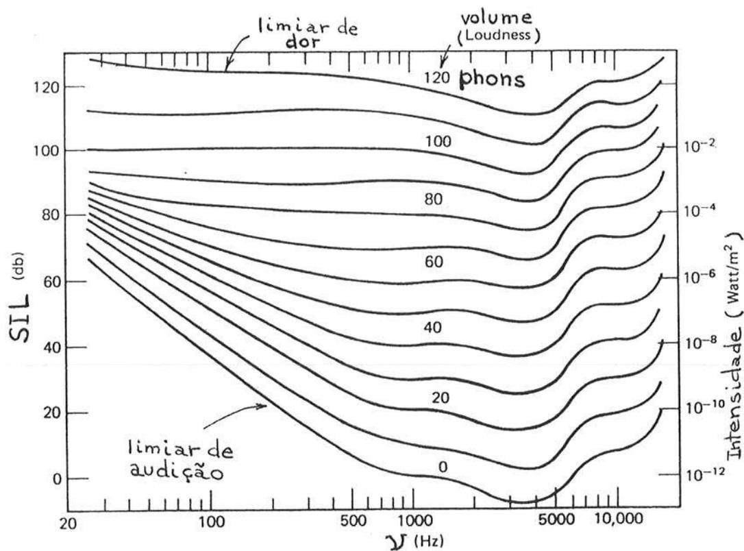
Figura 4: Curvas de nível de volume sonoro constante em função da frequência. Por definição, o número de phons coincide com o número de dB em 1000 Hz.
