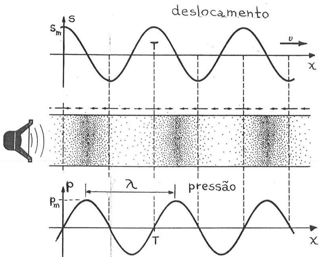
Figura 1: *Onda sonora na direção-x. A onda pode ser representada como uma onda de pressão ( $p$ ) ou como uma onda de deslocamento das partículas ( $s$ ).*
