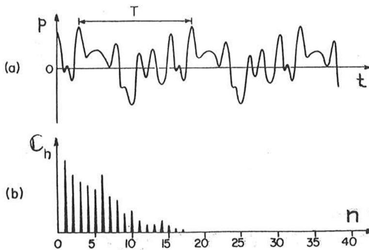
Figura 6: Forma de onda e espectro de Fourier da nota Si (493,88 Hz) tocada num violino (Referência 5).
