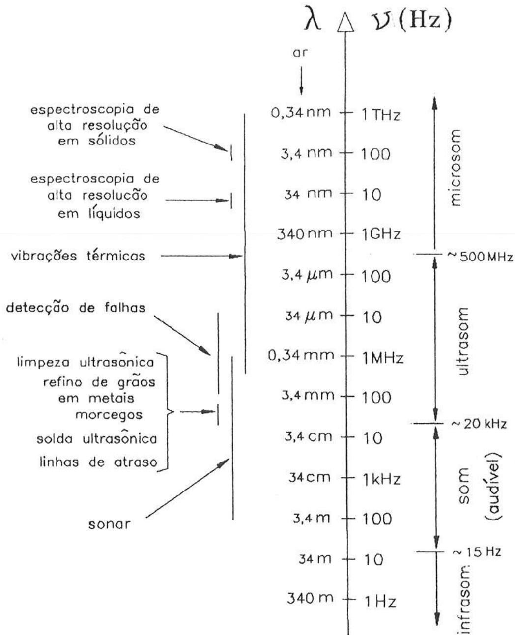
Figura 2: Ondas sônicas e alguns fenômenos típicos correspondentes.
