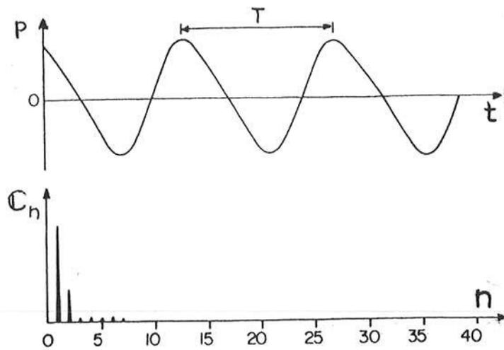
Figura 5: Forma de onda e espectro de Fourier da nota Dó (523,25 Hz) tocada numa flauta (Referência 5).
