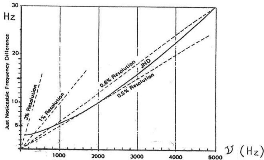
Figura 12: Diferenças apenas perceptíveis na frequência (*JND-frequency*) em função da frequência do tom puro (Referência 8).
