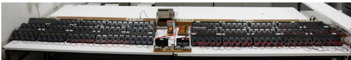
**Figura 1:** Esquema da montagem utilizada para estimar os erros em medições dos multímetros por meio de  $NA$  ligações em série com um amperímetro de precisão e/ou  $NV$  ligações em paralelo com um voltímetro de precisão. [créditos da foto: Paulo R. Pascholati]
