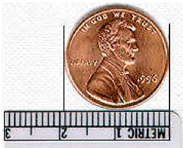
Figura 1.2. Medindo o diâmetro de uma moeda.
